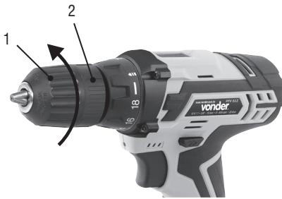
Fig. 2 – Abertura do mandril
