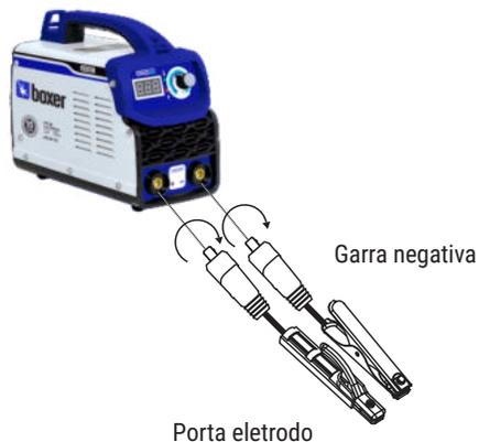
1 - Conecte o **porta eletrodo** ao pólo positivo da máquina e tenha certeza de que ao girar o mesmo esteja bem fixado. Evite mau contato.
