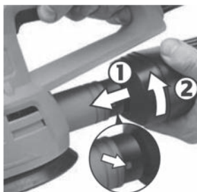
Fig. 4 - Montagem e desmontagem do coletor de poeira
