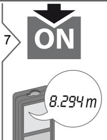
**i** O resultado é exibido na linha principal e a distância medida acima. Acionar a tecla de medição por 2 seg na função ativa automaticamente a medição máxima ou mínima.
