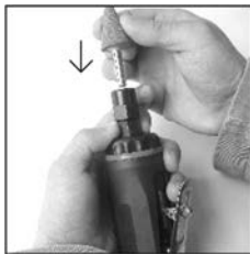
Fig. 3 – Instalando una punta montada.
