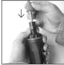
Fig. 3 – Instalando uma ponta montada.
